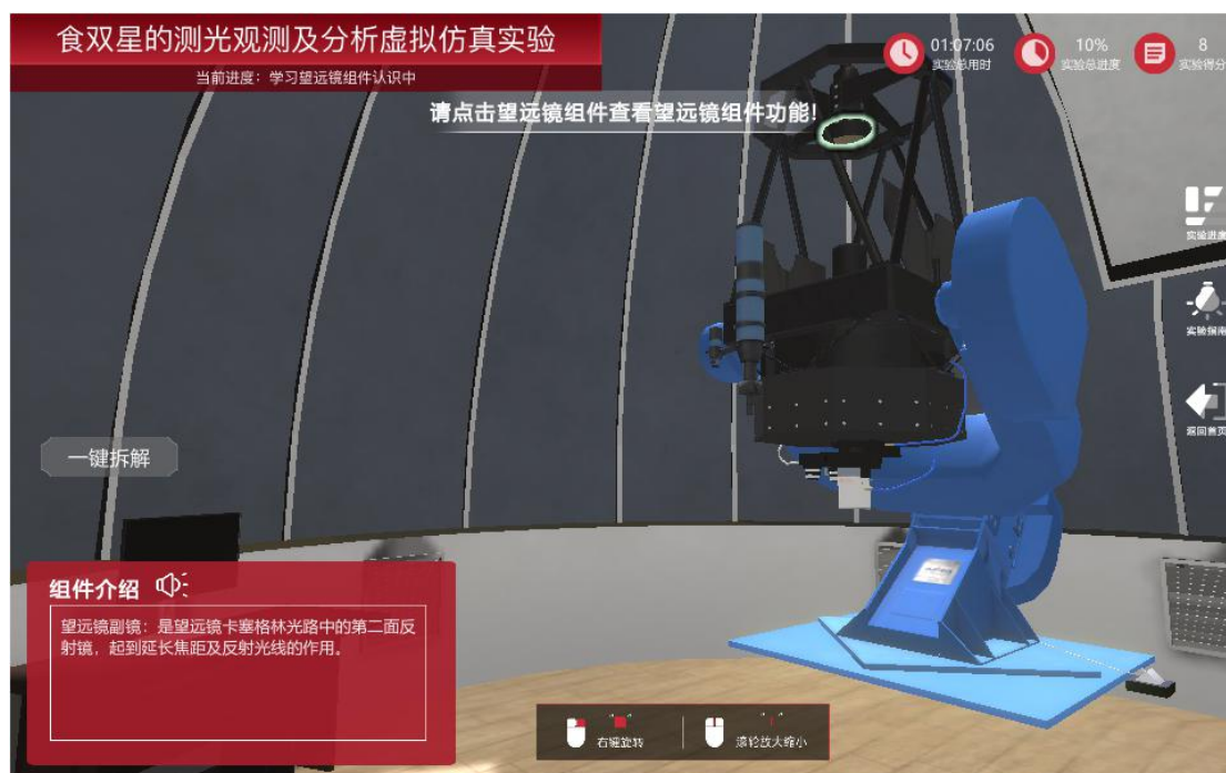
图 21 望远镜组件介绍-望远镜副镜
