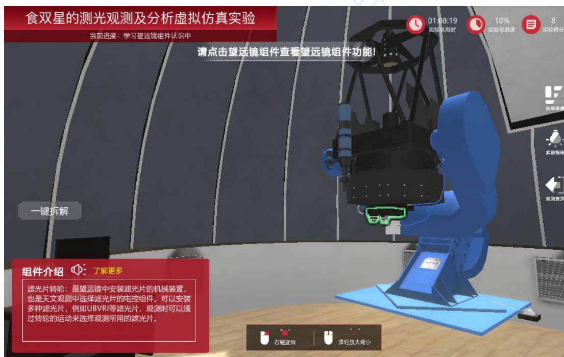
图 26 望远镜组件介绍—滤光片转轮
